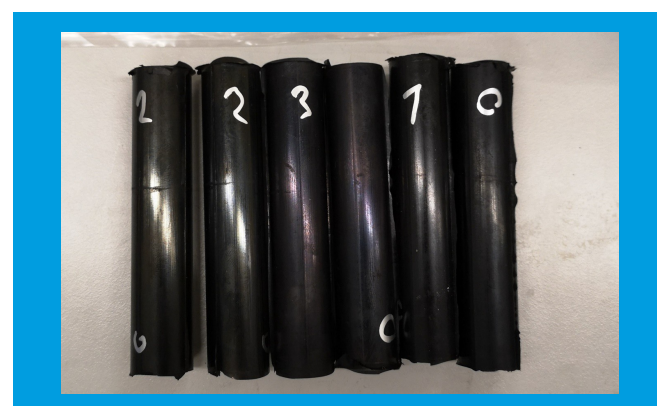
(4) Ozongealterte Probekörper: Verfärbung der Oberfläche lastfrei gealterter Proben, Rissbildung unter Zug, gelbliche Ausblühung des Ozonschutzmittels nach Dehnung Tělíška vystavena ozonovému stárnutí: změna barevnosti povrchu před a po stárnutí, tvorba trhlin pod napětím, migrace antiozonantu na povrch tělíška poprotažení
