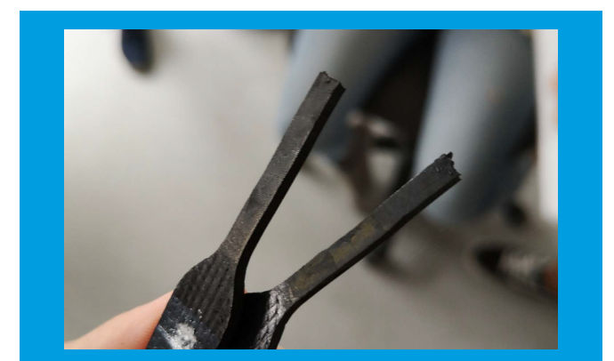
(4) Ozongealterte Probekörper: Verfärbung der Oberfläche lastfrei gealterter Proben, Rissbildung unter Zug, gelbliche Ausblühung des Ozonschutzmittels nach Dehnung Tělíška vystavena ozonovému stárnutí: změna barevnosti povrchu před a po stárnutí, tvorba trhlin pod napětím, migrace antiozonantu na povrch tělíška poprotažení
