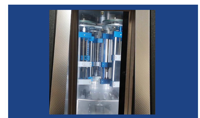
(3) Voralterung in der Ozonkammer Průběh stárnutí v ozonové komoře
